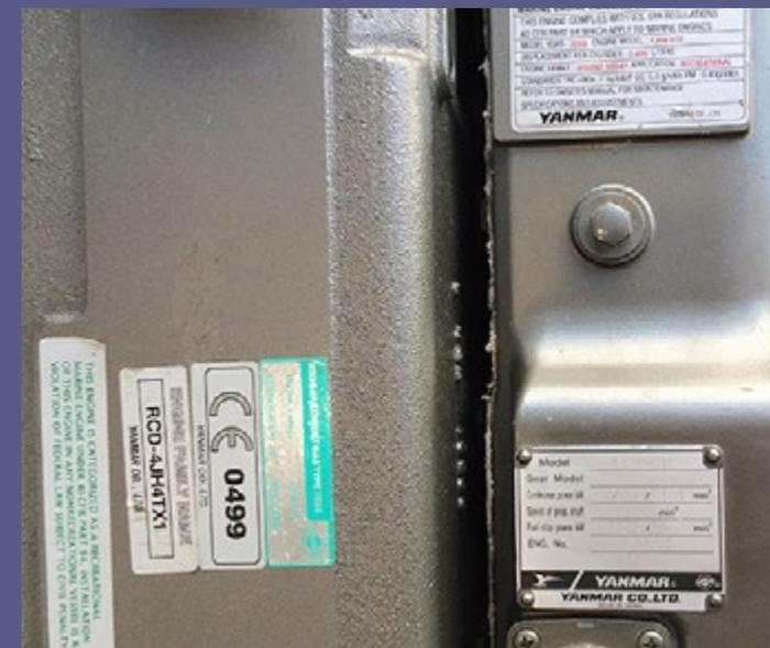
Das genaue Aussehen der Motoridentifizierung ist dem Hersteller überlassen. Sie muss jedoch immer die oben aufgeführten Angaben enthalten.
