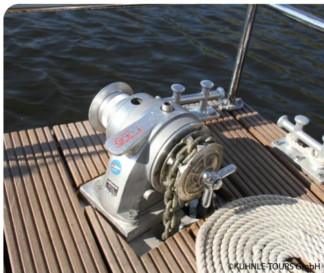
Alle Wasserfahrzeuge müssen unter Berücksichtigung ihrer Entwurfskategorie und ihrer Merkmale mit einer oder mehreren Halterungen oder anderen Vorrichtungen ausgerüstet sein, die das Anker-, Vertäuen- und Schleppen ermöglichen und der entsprechenden Belastung sicher standhalten.
